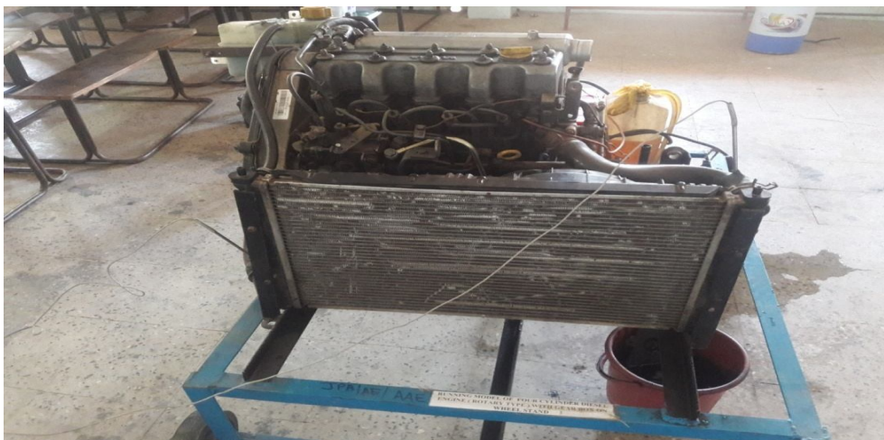
Fig. 2 Actual Experimental Radiator Test-rig.
